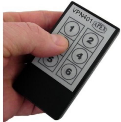
Der Kommandosender VPN 401 dient so zur Kommunikation zwischen dem Blinden und Sehbehinderten und dem Haltestelleansagegeräten, die in den Stadtverkehrsfahrzeugen eingebaut sind. Der Kommandosender VPN401 ist mit sechs Tasten ausgerüstet und er ermöglicht das Absenden von sechs verschiedenen Befehlen.
